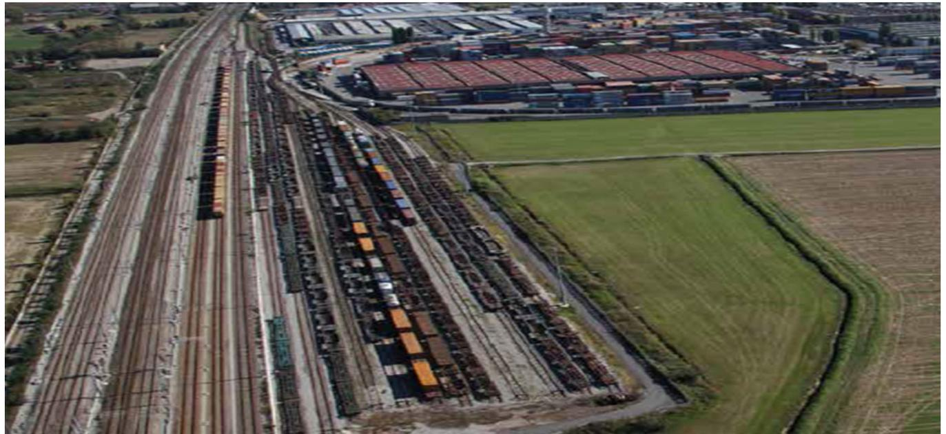
Figura 12: Vista dell'impianto da ovest (direzione Milano), con evidenza in primo piano dei fasci ferroviari esterni di appoggio, in fregio alla linea (4 binari) Milano – Treviglio
